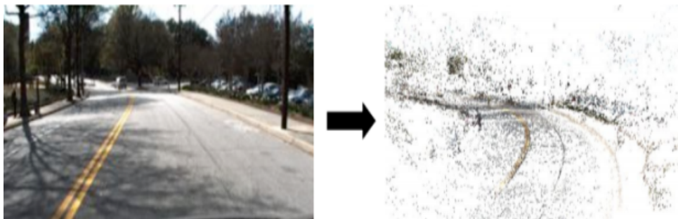
Figura 2.6: Os quadros rastreados formam uma nuvem de pontos 3D. Fonte: (STIVANELLO et al., 2008).
