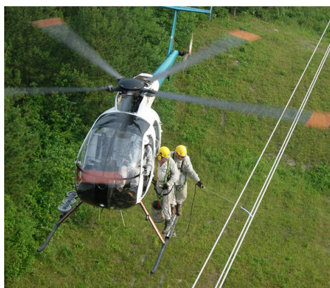
Figura 1 – Inspeção de linhas de transmissão realizadas por aeronaves tripuladas
