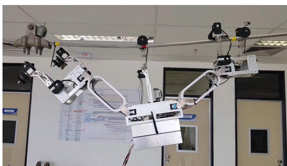
Figura 28 – Deslocamento do PIRo com a unidade traseira abaixada
