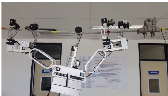
Figura 24 – PIRo com unidade frontal levantada e garras abertas
