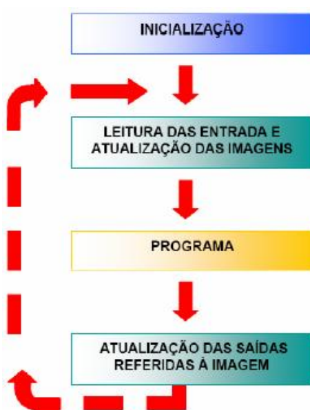
Figura 10 - Ciclo de processamento do CLP Fonte: SILVA FILHO (2008).
