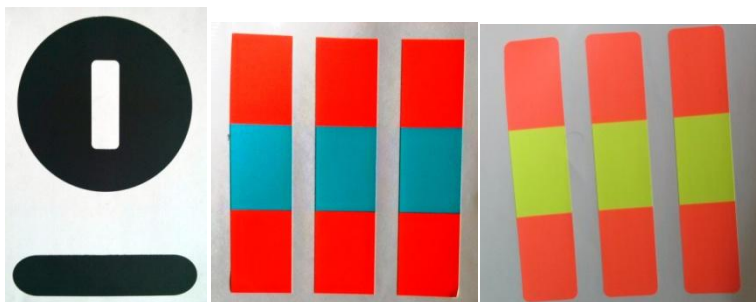
Figura 9: Padrões inclusos na caixa do AR.Drone que podem ser reconhecidos pelo firmware . Na esquerda o oriented roundel , no meio e na direita adesivos coloridos originalmente para serem colados no AR.Drone para reconhecimento de aeronaves inimigas.
