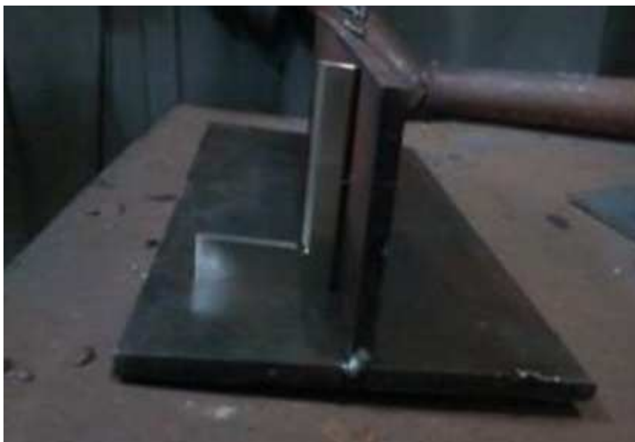
Figura 4.3 As chapas depois ter submetidas à tratamento de alívio de tensões foram ponteadas com processo MAG controlando o esquadrejamento inicial de 90°.
