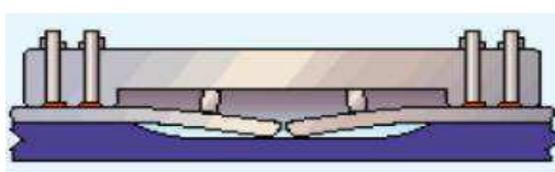
Figura 3.17 Pré-encurvamento obtido por meio de cachorro e calços. (TWI,2014).
