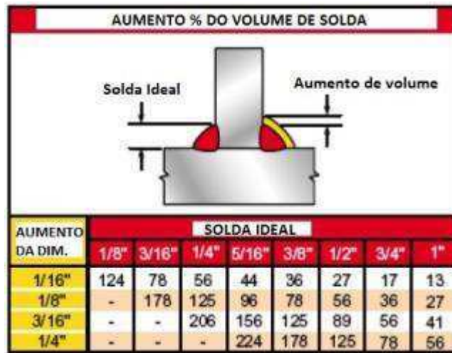
Figura 3.6 Aumento % do volume de solda e da distorções, (Adaptado BLODGETT,2014).
