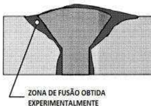
Figura 2.6 Zona de fusão de uma junta de topo onde aplicar as contrações. (Adaptado BACHORSKY, 1999)
