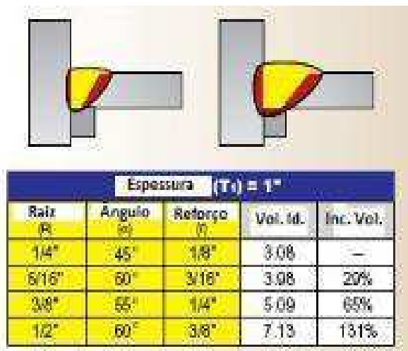
Figura 3.21 Aumento % do volume de solda em função da abertura de raiz e do ângulo de chanfro variando simultaneamente. (Adaptado BLODGETT,2014).
