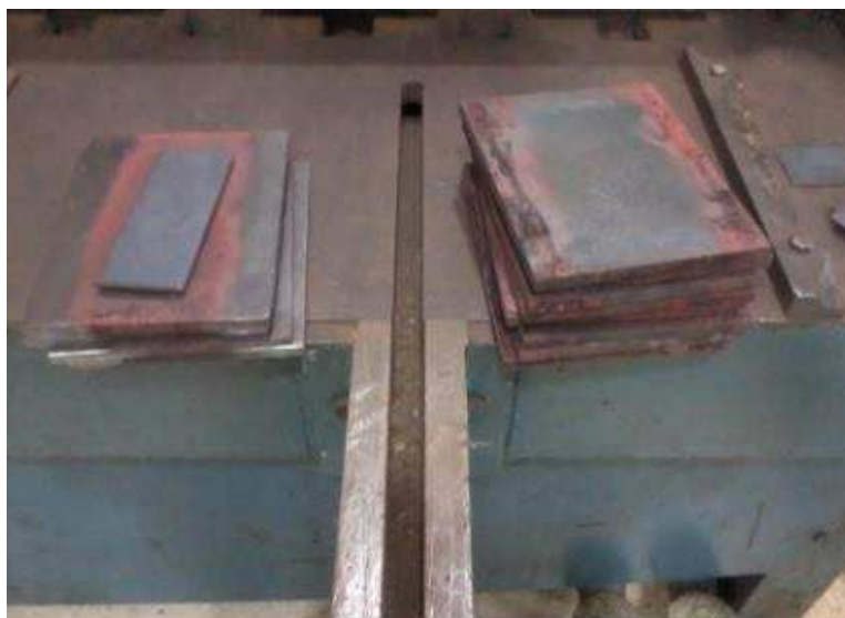
Figura 4.2 Chapas cortadas e esmerilhadas
