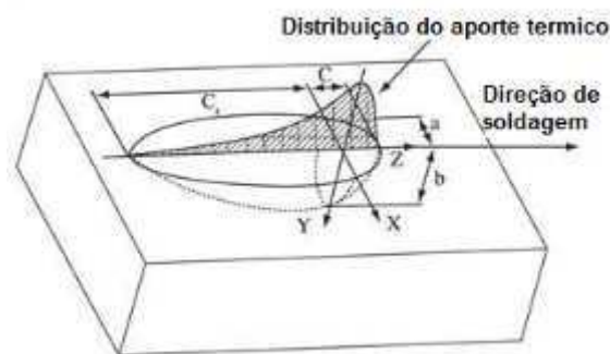
Figura 2.10 Modelo do duplo elipsoide de Goldak
