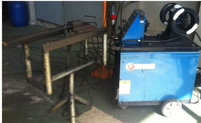
Figura 19: Máquina de metalização “Arc Spray” e pistola com extensão para aplicações internas.
