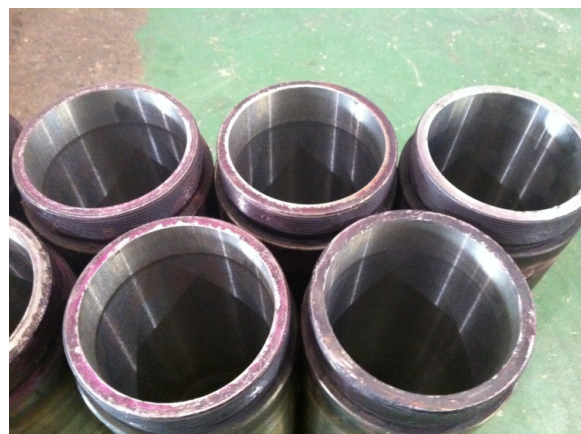
Figura 21: Camisas de assentamento recuperadas, overlay e metalização; ombreira com 35mm.
