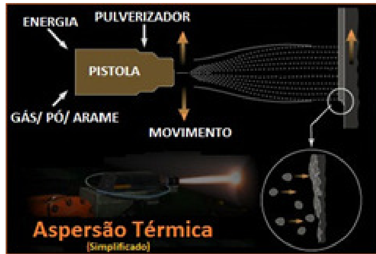
Figura 1: Esquema de deposição por aspersão térmica.
