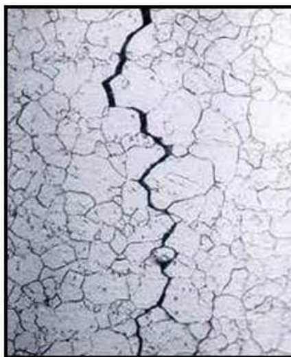
Figura 17 – Trinca intergranular devido à corrosão sob tensão em inconel 500X
