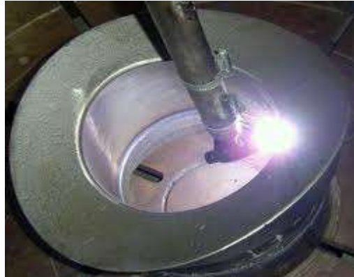
Figura 9 – Foto de soldagem overlay de um bocal
