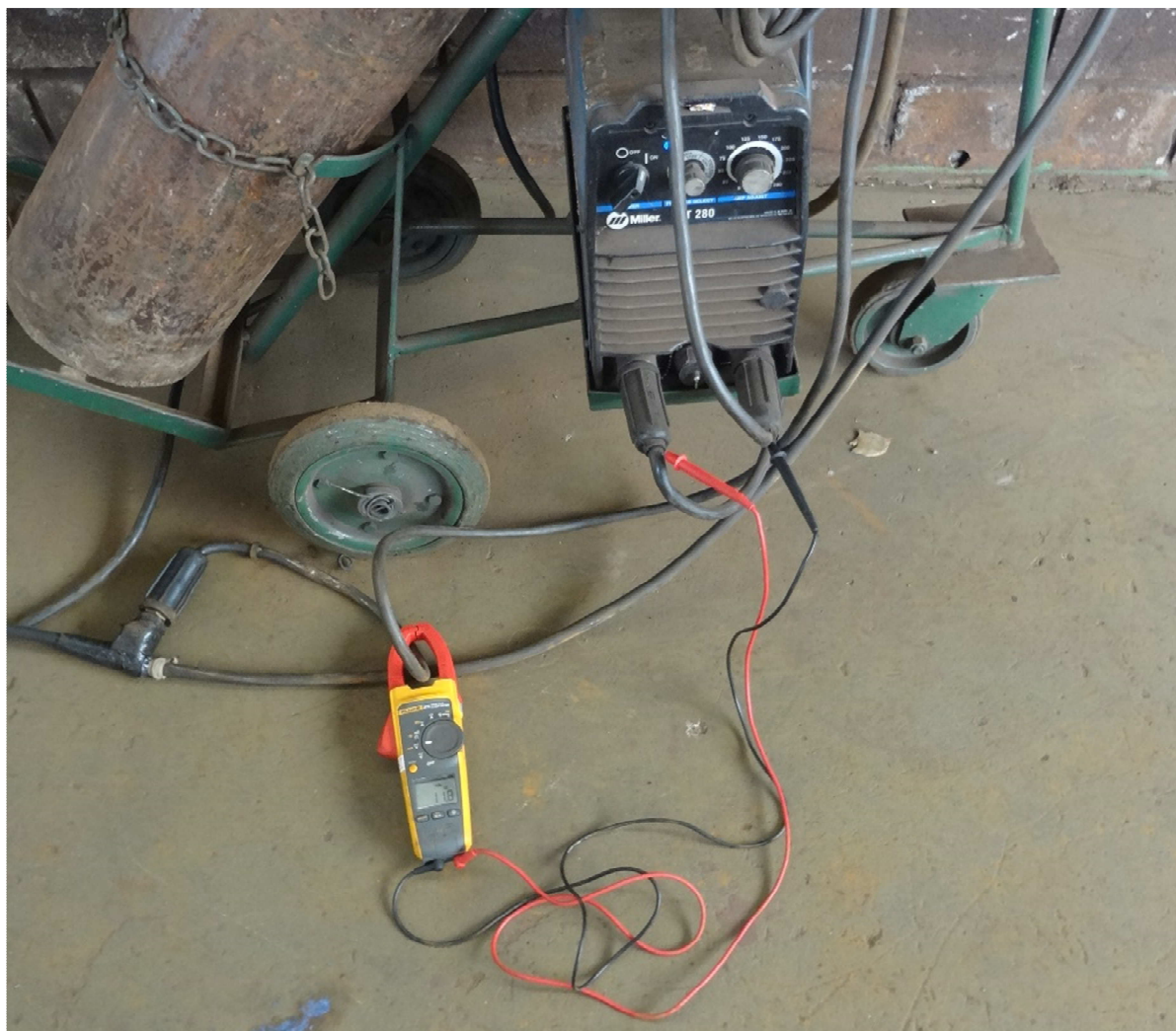
Figura 31 - Alicate Volt-amperímetro instalado na máquina CST 280.
