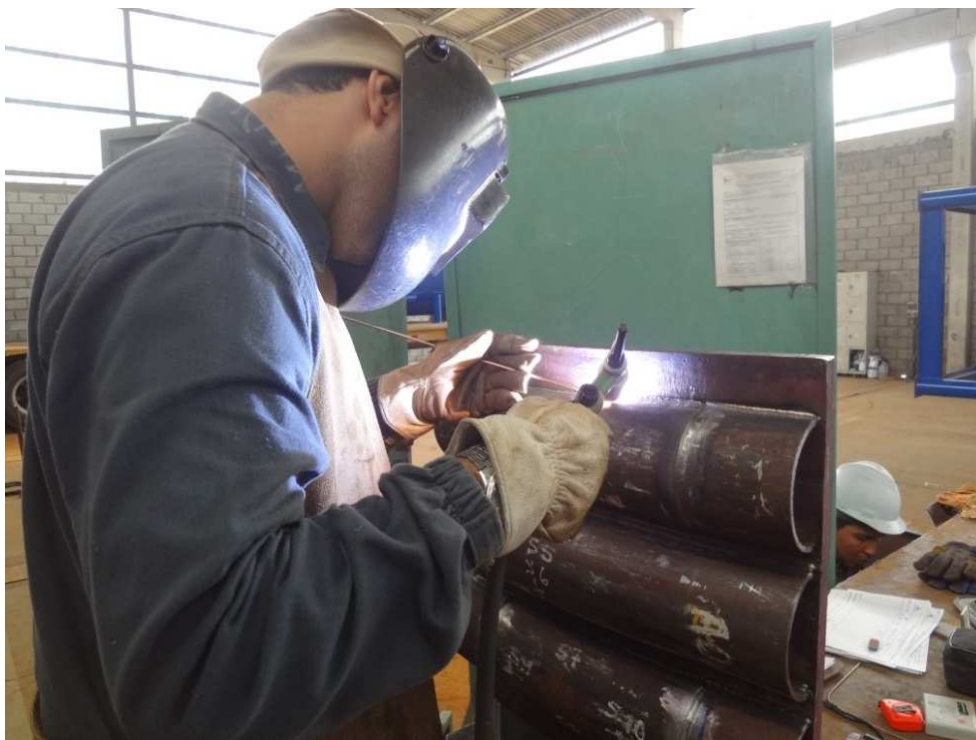
Figura 26 - Soldador em posição de soldagem simulando condição de campo.
