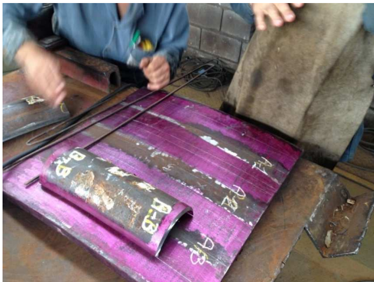
Figura 27 - Limpeza das chapas e tubos e aplicação de verniz protetor.
