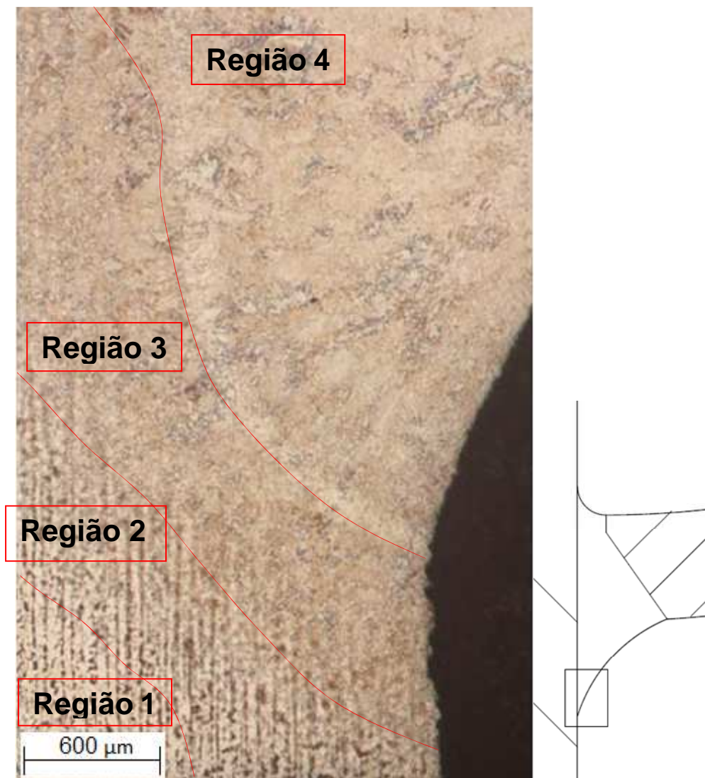
Figura 55 - ZTA da chapa, face da solda. Faixa da ZTA relativamente estreita sem anormalidades. Aumento: 25x
