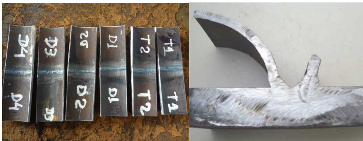
Figura 33 - Amostras cortas para ensaio metalográfico e microdureza.
