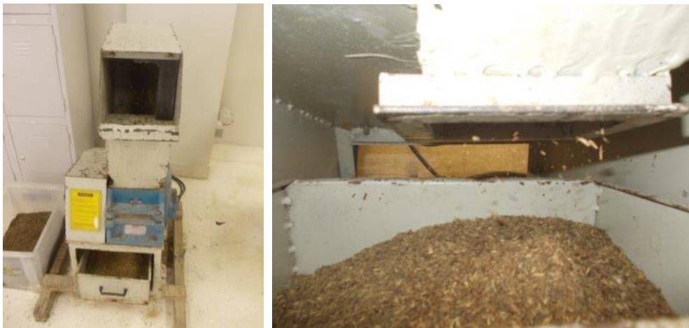
Figura 31 – Amostras processada no moinho Triturador – marca Mecanofar
