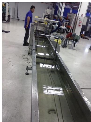
Figura 35 – e)Tanque de resfriamento / f) fibra sendo encaminhada para o granulador
