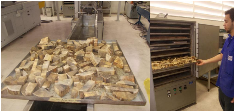
Figura 30 – Amostras fatiadas na Estufa Palley
