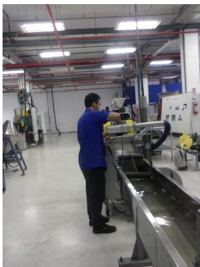
Figura 35 – e)Tanque de resfriamento / f) fibra sendo encaminhada para o granulador
