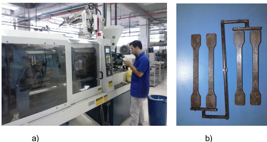
Figura 37 – a) Injetora / b) corpo de prova compósito de mandacaru
