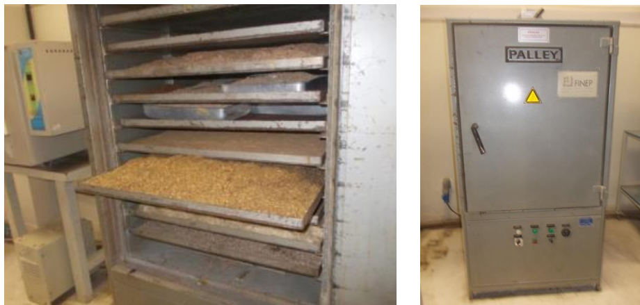
Figura 32 – Amostras processada na estufa Palley
