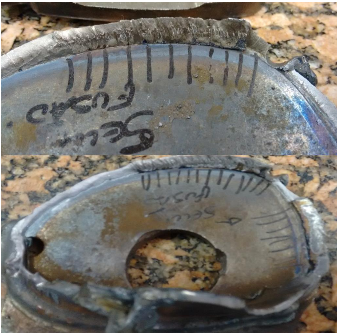
Figura 4 – Foto da flange com falta de fusão Fonte: Autoria própria
