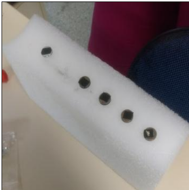
Figura 20: Fitas condutivas de carbono coladas sobre as amostras.
