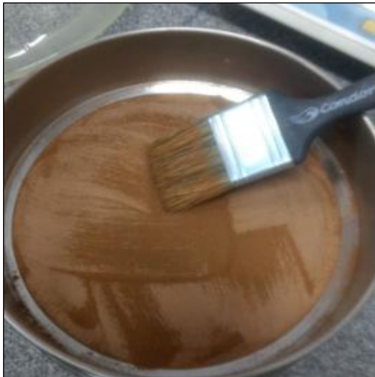
Figura 19: Peneiramento das amostras na abertura #325 mesh.
