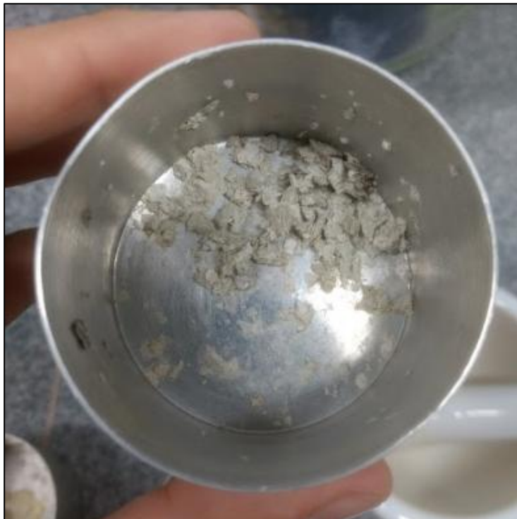
Figura 17: Amostra 04, entrada do trocador de calor.
