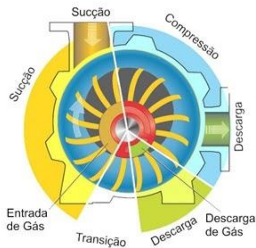
Figura 5: Funcionamento bomba de vácuo de anel líquido.
