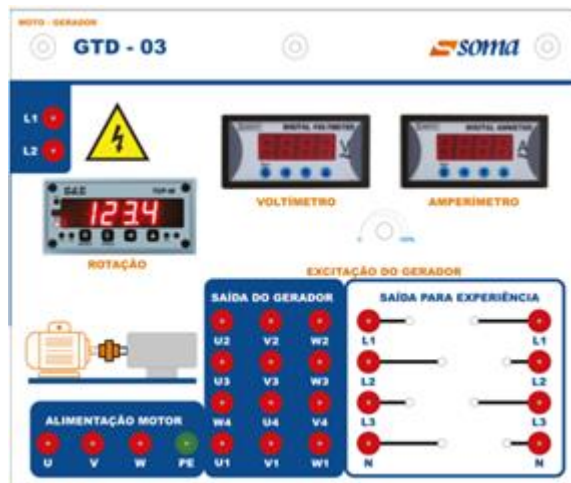
Figura 16 - Módulo Moto-Gerador (GTD-03)
