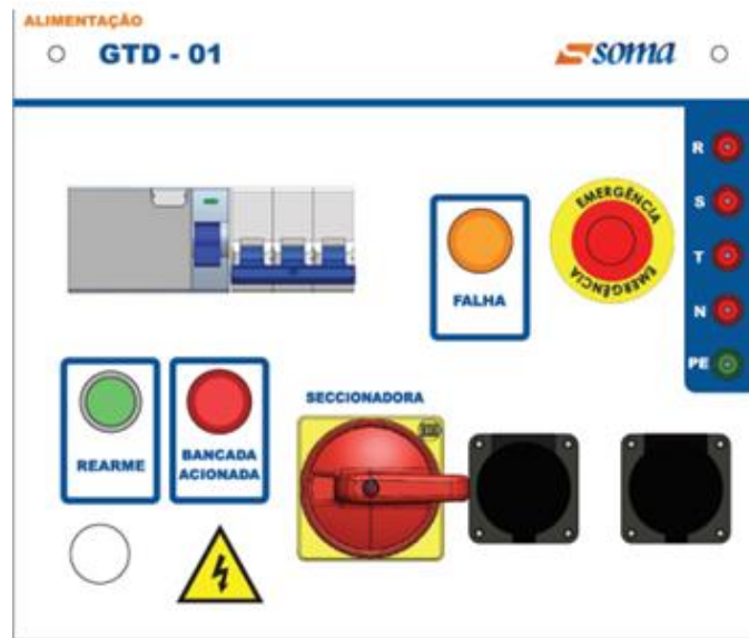
Figura 13 - Módulo de Proteção e Seccionamento (GTD-01)
