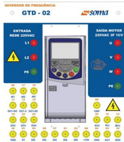
Figura 14 - Módulo Inversor de Frequência (GTD -02)
