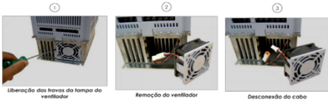
Figura 27 - Procedimento de Retirada do Ventilador.
