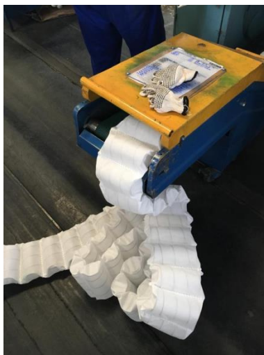
Figura 51: Final de operação - Mola no seu estágio final, ensacada e pronta para ser montada.
