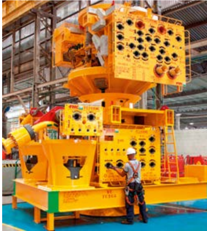
Figura 1.3: Árvore de Natal Molhada sendo montada em um fabricante
