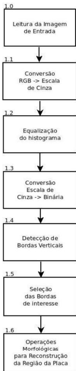
Figura 6: Fluxograma do algoritmo de localização e segmentação de placas de veículos.
