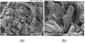
Figura 2: Micrografia da superfície de fratura dos compósitos: (a) 65% de Farinha de Madeira; (b) 70% de Farinha de Madeira
