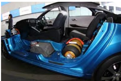
Figura 10. Tanque de hidrogênio sob o banco traseiro. [5]
