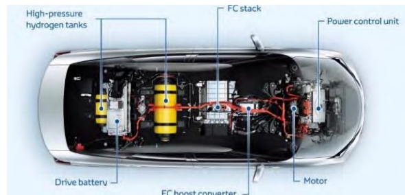
Figura 2. Sub-sistemas do Toyota Mirai. [5]
