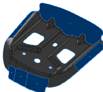
Figura 5-7: Faces com restrição fixa (em destaque)
