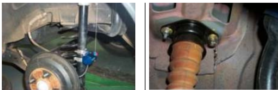
Figura 5-3: Instalação de transdutor em suspensão automotiva (cortesia da Ford Motor Company© do Brasil Ltda)
