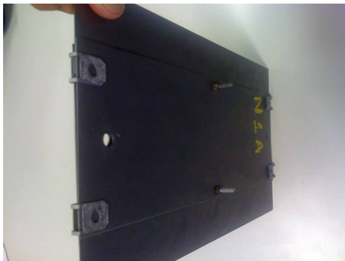
Figura 4.2: CP vista de topo do CP com AL galvanizadas passadas pelo processo de pré-tratamento.
