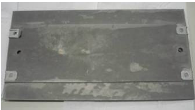
Figura 4.1: CP vista superior do CP com AL galvanizadas passadas pelo processo de pré-tratamento.
