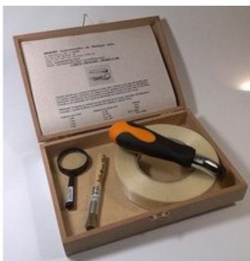
Figura 5.8: Kit para teste de aderência mostrando lâmina riscadora, fita adesiva específica e lupa.
