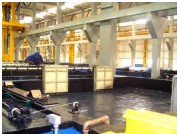
Figura 4.9: Foto ilustrativa da instalação do processo de pintura "Stop and Go" – Pintura e-coat
