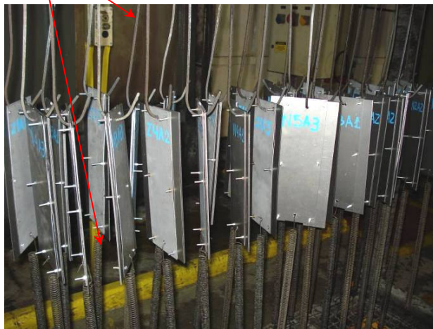
Figura 4.7: CPs fixados na gondula de processo por molas e gancheiras
