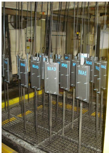
Figura 4.5: CPs tipo A antes de iniciar o experimento fixados na gondula de processo por molas e gancheiras
