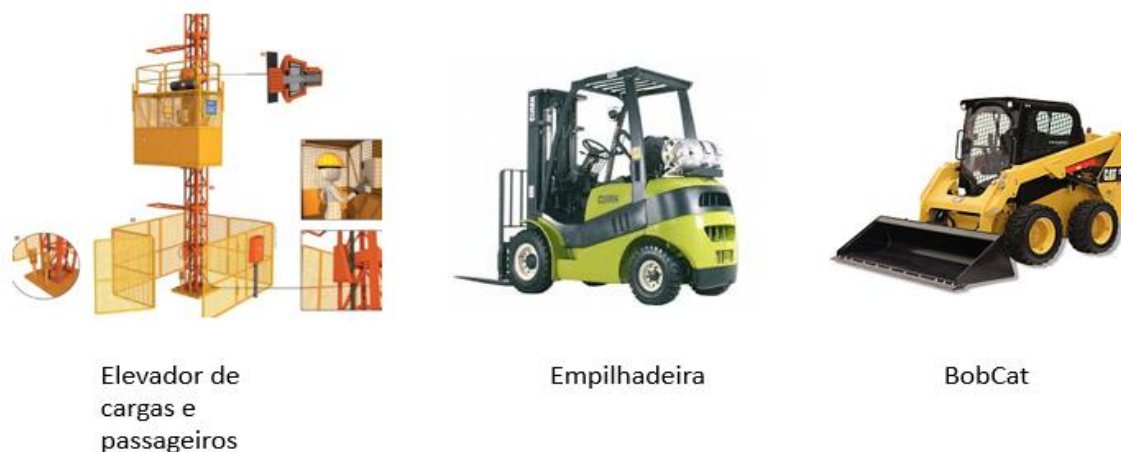
Figura 6: Equipamentos de transporte de materiais e pessoas no canteiro de obras.
