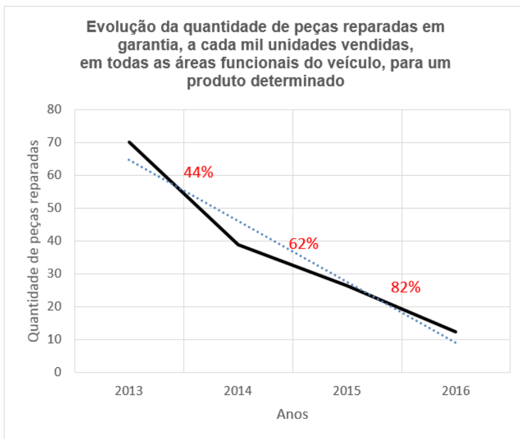
Gráfico 5: Evolução da quantidade de peças reparadas em garantia, a cada mil unidades vendidas, em todas as áreas funcionais do veículo, para um produto determinado (elaborado pelo autor, 2016).
